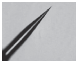
图6 电源频率为95 kHz的泰勒锥
